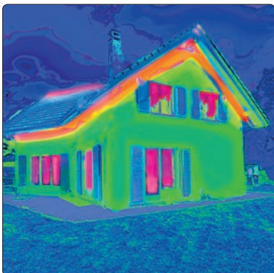
Eine Wärmebildkamera entlarvt veraltete und undichte Fenster.
