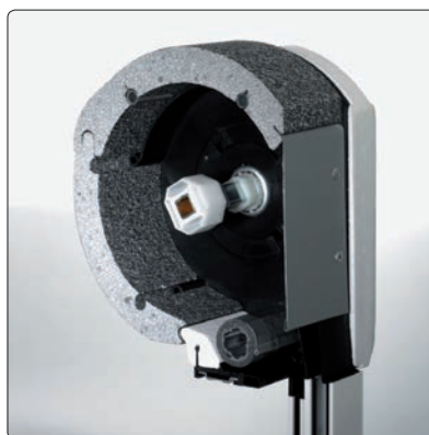
Der PaXtermo Rollladen ist besonders geeignet für die Renovierung. Er wird in den vorhandenen alten Rollladenkasten integriert und bringt ihn auf hervorragende Wärmedämmwerte.
